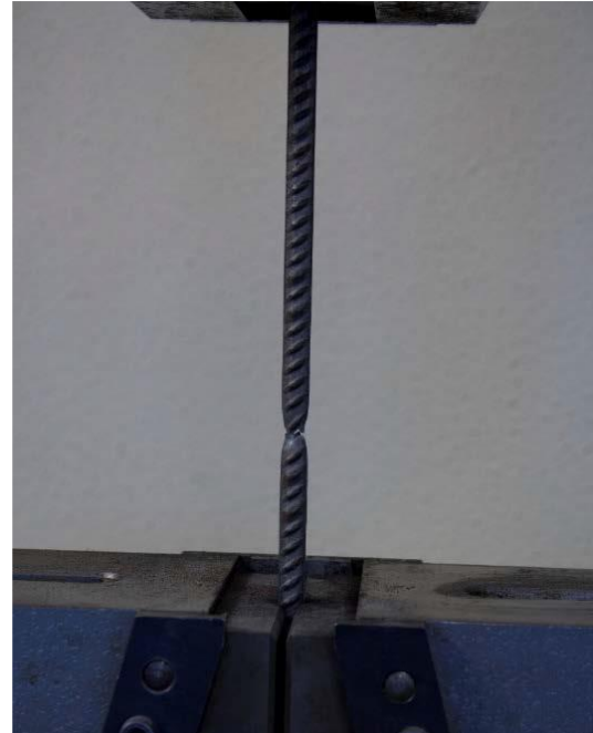
Şekil 7673. Çekme testi makinesi ve test edilen numune.
