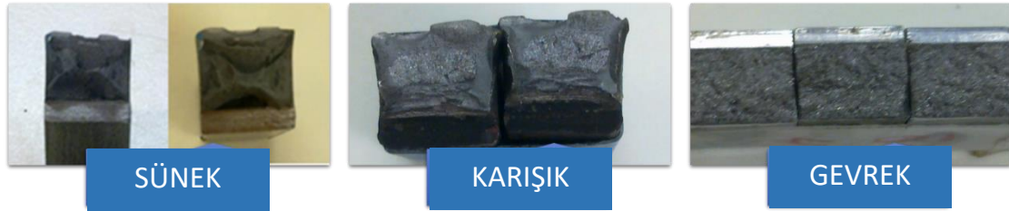
Şekil 7370. Charpy testine tabi tutulan numunelerin kırılma yüzeyi.
