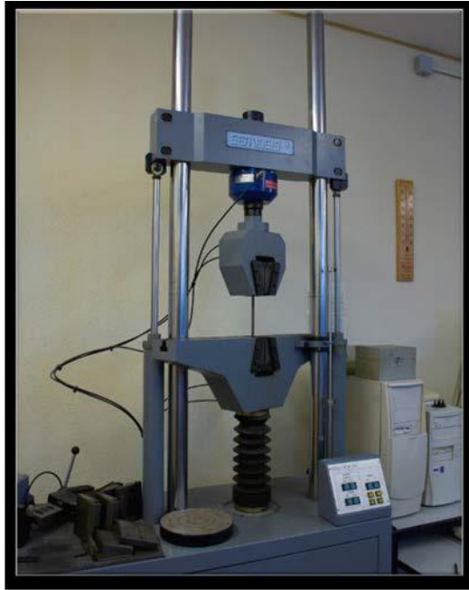
Şekil 7673. Çekme testi makinesi ve test edilen numune.
