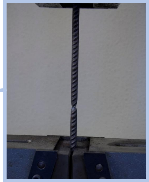
Εικόνα 76. Μηχανή δοκιμής εφελκυσμού και δοκιμασμένο δείγμα.
